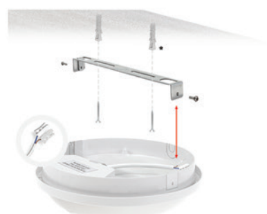
Mocowanie śrubą od boku Side screw mounting
